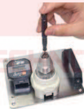
通过小型扭力螺丝刀AMRD的ATGE-G进行扭矩检查的示例 (使用选配件ATGE-G测定台)
