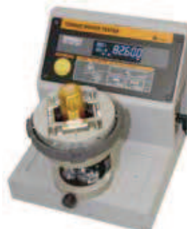
扭力螺丝刀RTD (左)、FTD (右) 的扭力螺丝刀检测仪的校正示例
