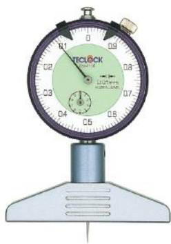
DM-210P 直読仕様の標準タイプ 測定範囲：10mm ・針状測定子
