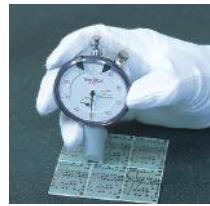
DM-251を用いた プリント基板の溝の深さ測定
